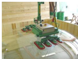
VA813: Gebogen glas zuiger, 400kg, kantelbaar en draaibaar 360 graden.
