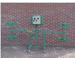
VA819: Een sandwich dak panelen zuiger, verstelbaar met valbeveiliging om dakpanelen tot ongeveer 12m lengte te plaatsen. Kantelbaar en draaibaar 360 graden, geschikt voor 250kg.
