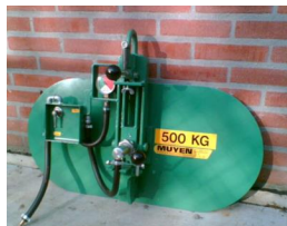
VA811/VA812: Ovale zuignap 500kg, 750kg en 1200kg, kantelbaar en draaibaar 360 graden.
