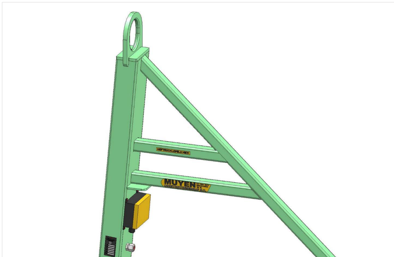
Figuur 6: Extra koker (bovenste) voor het hijsen en vervoeren met een heftruck
