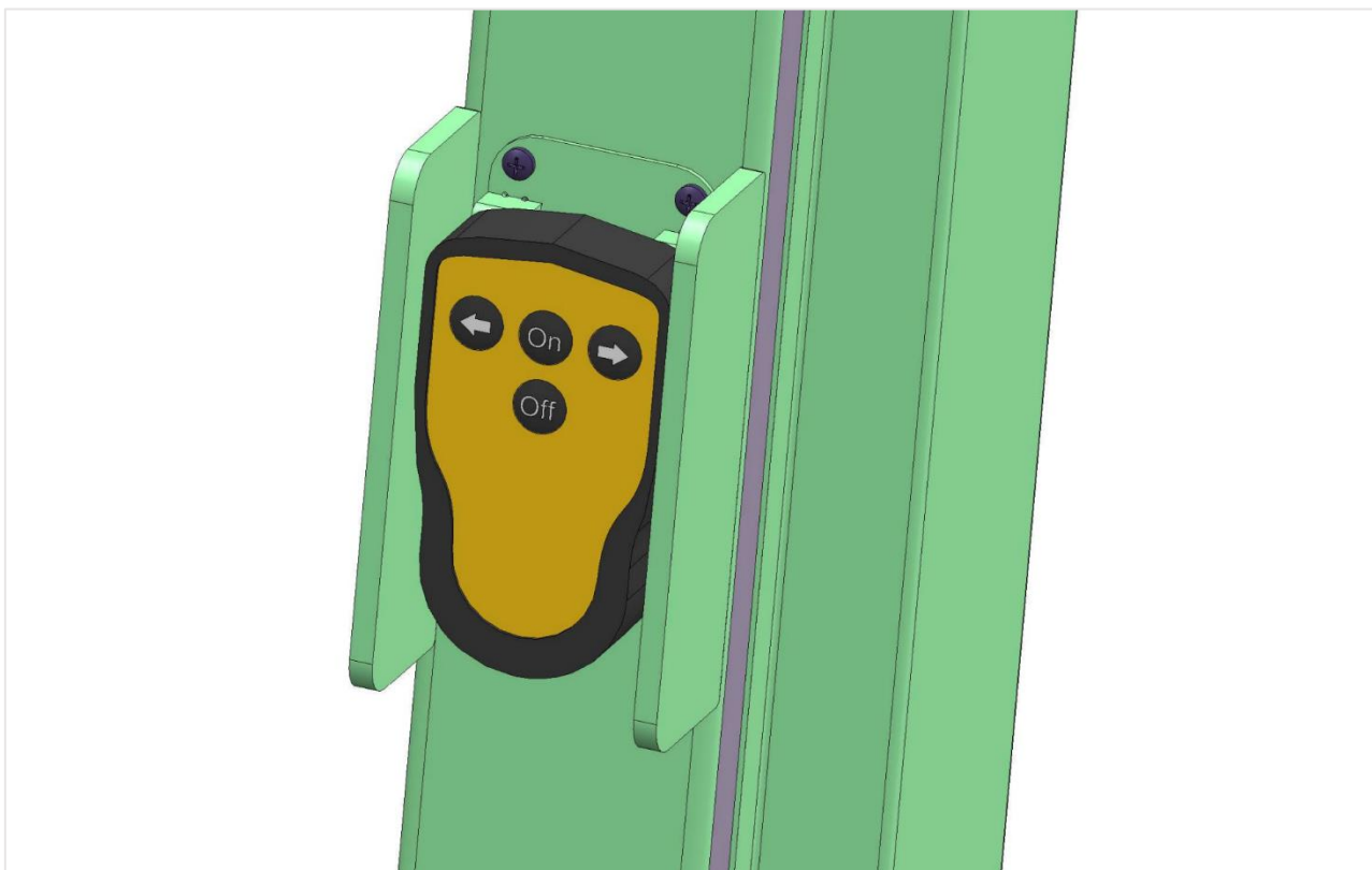
Figuur 5: Afstandsbediening voor het bedienen van het contragewicht
