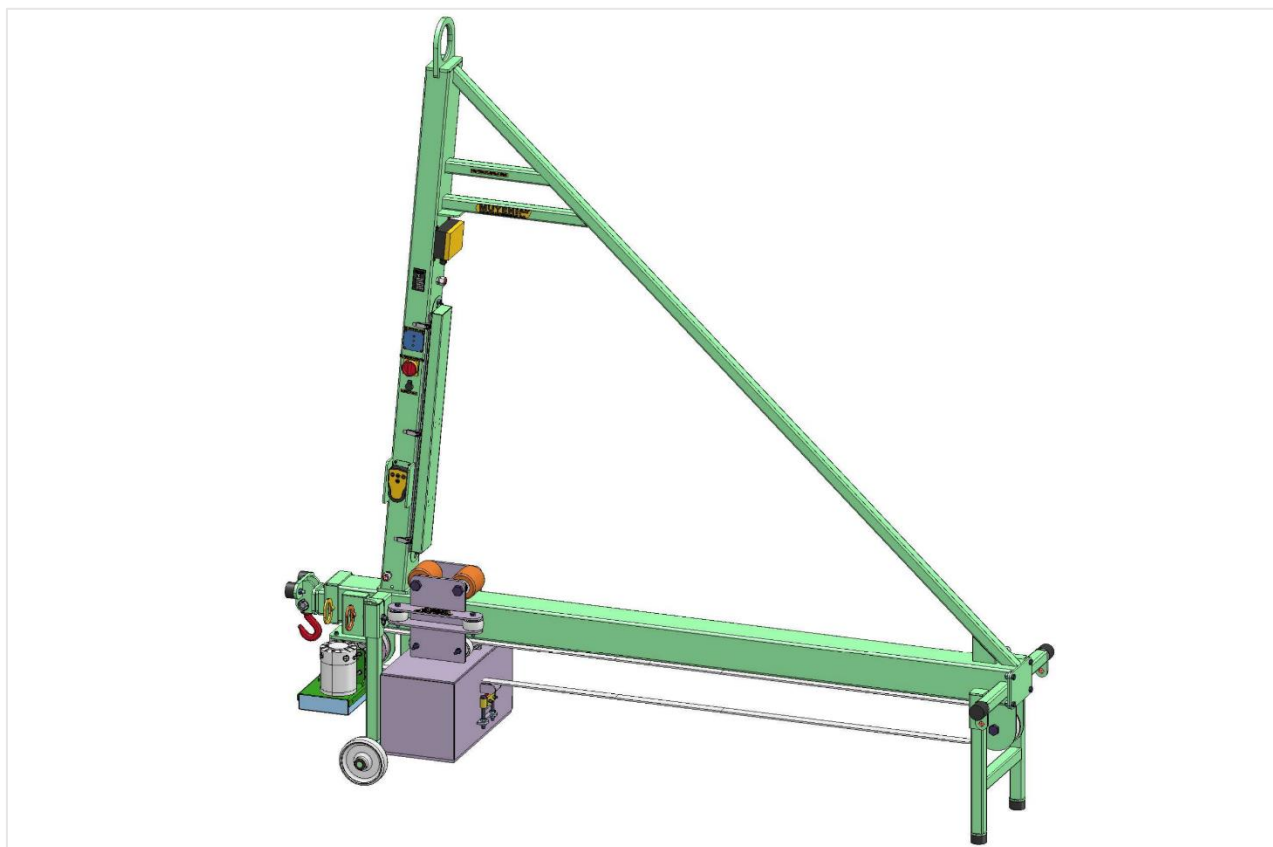
Figuur 7: Bij transport: contragewicht aan de voorzijde en schuifstukken volledig inschuiven
